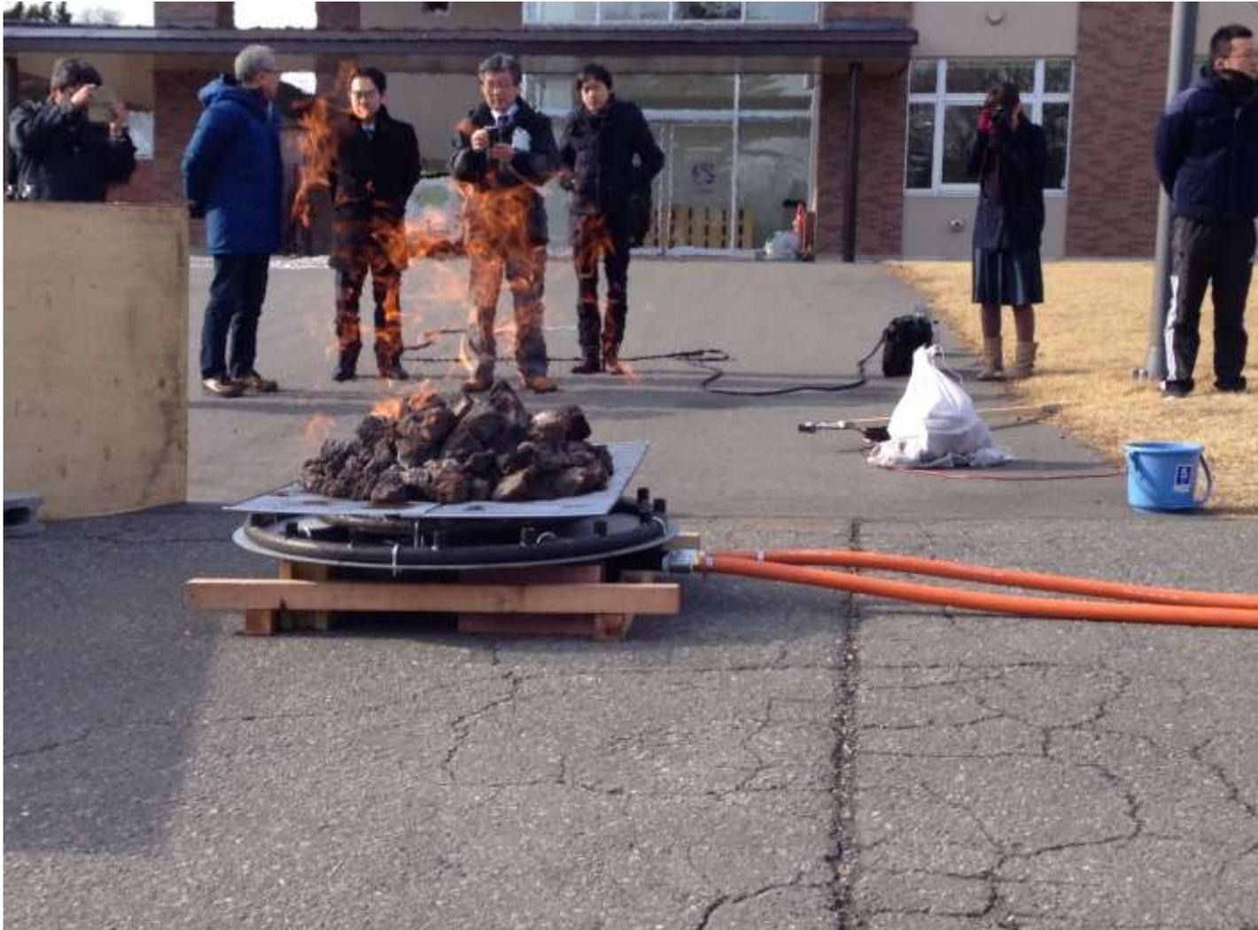
燃焼実験。内輪のみで燃焼時の様子。内輪へメタン190L/minで供給
